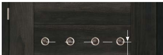
Szellőző nyílások: - szárny szélesség "60", "70" - 4 db.
